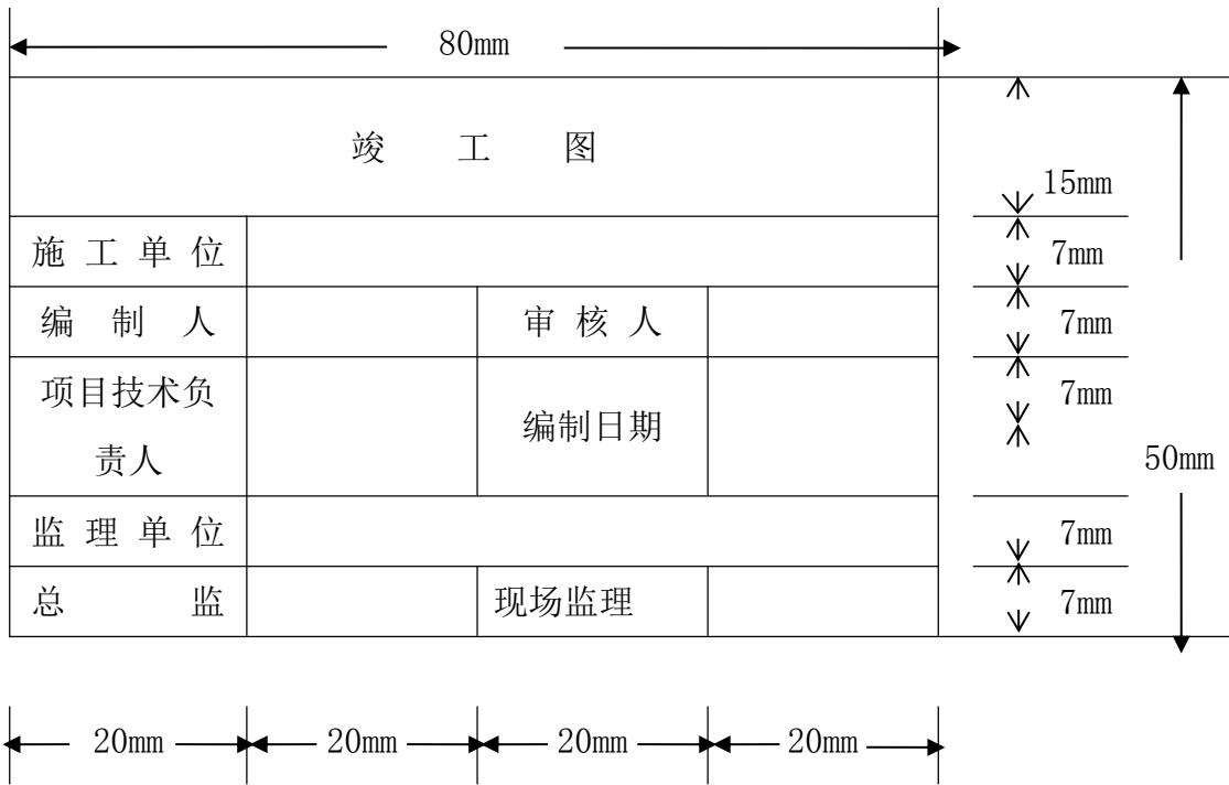
(三十四) 施工图涉及变更量不大时，可利用施工图改绘成竣工图（变更内容需用碳素墨水笔在施工图上标示清楚），同时还必须以变更图章标明变更修改依据，变更图章尺寸为：35mm×15mm。
