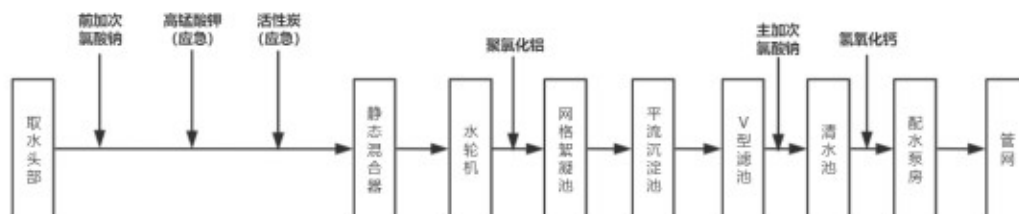
图 6-2 凤凰水厂生产工艺流程图
